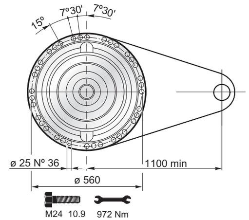
La coppia massima indicata è valida solo con calettatori forniti da Planetary Drives
